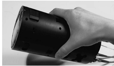
図2 モジュール型OPAMの外観。底面積 64 \text{cm}^2 、高さ 19 \text{cm} 程度の円筒型で、カリウムを封入した立方体ガラスセルを有す。
