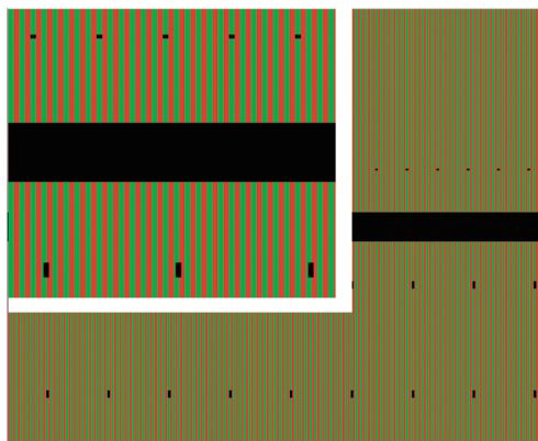
図2 赤緑縞の画像例（左上部：拡大図） （印刷の際、モアレが発生する危険性がある） ・水平x: 640画素, 垂直y: 480走査線（画素） ・時間：コマ番号（0～17繰返し）、 ・赤緑縞パターン：6画素周期の正弦波。2画素／フレームで左行する。 ・デモ観視の際、少なくとも初めは適当に何かで遮って、上半部あるいは下半部のみを観るようにするとよい。
