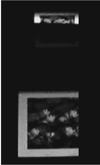
図1 ディスプレイの高速撮影. 同一のビデオ信号を分配し, CRT ディスプレイ (上) と液晶ディスプレイ (下) に同時提示した条件で 1000 フレーム毎秒での動画撮影を行った. 写真はその 1 フレームを示す. CRT が走査線で描いていることが明瞭にわかる一方で, LCD は静的な画像表示であることがわかる. 注意: 下の LCD 画像は右側が撮影サイズで切れている. 詳細な動画は YouTube にて公開している. http://www.youtube.com/watch?v=oyT2mBfzcOw
