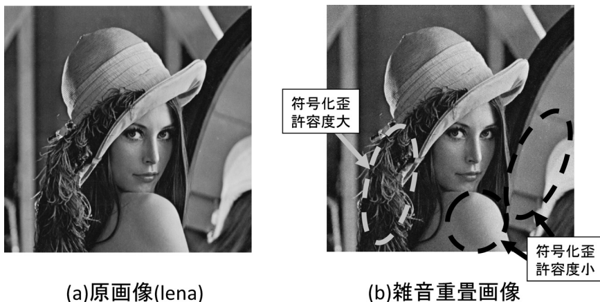
図6 マスキング効果の実例. 原画像 (a) およびそれに MSE=32.3 の加法的白色ガウス雑音を加えた雑音重畳画像 (b).
