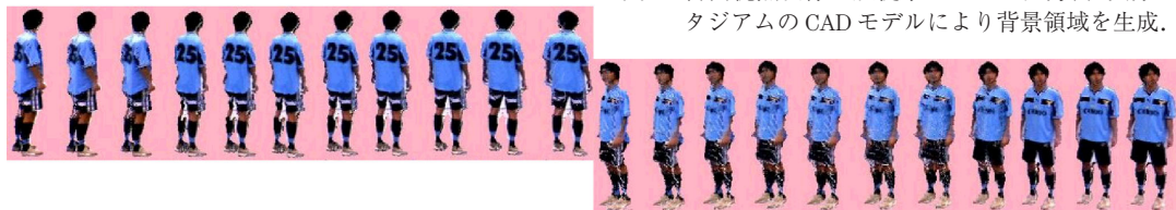
図11 自由視点映像生成例. 生成フレームレート平均毎秒15フレーム. 観察者から物体までの距離が±25(m)の地点において観察者視点をX=4.7(m)から-1.5(m)まで移動。
