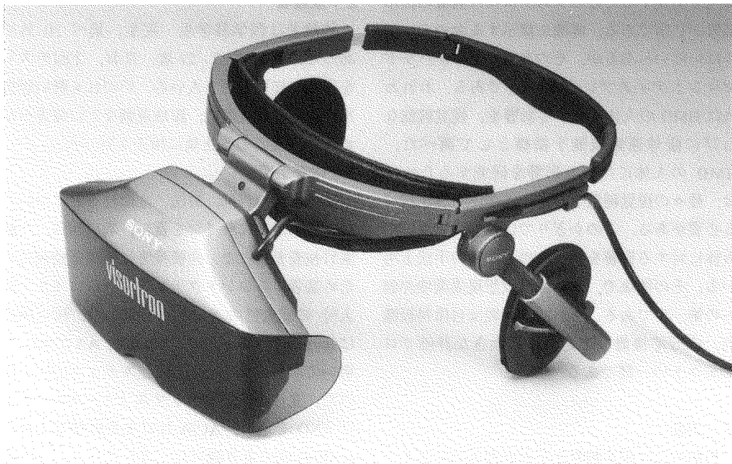
図1 バイザトロン。眼鏡をかけたまま使用できるため、ピント調節機能はない。See through型。イヤホンつきであるが、タスク中には使用していない。右端の線はコントロールボックスにつながる。
